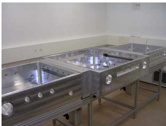
Figure 1 Construction de l'installation de dépôt du silicium en couches minces, à chambre double, basée sur la KAI-M plasma box d'oerlikon (Source: IMT)
